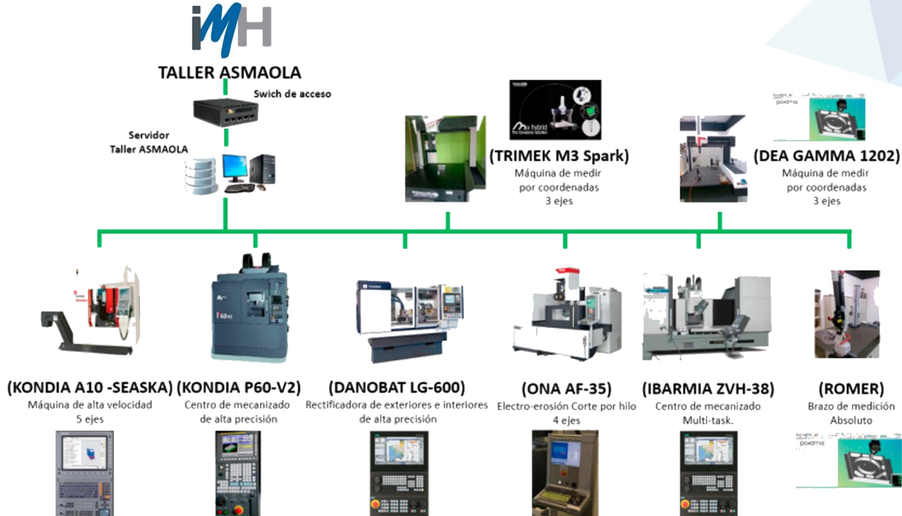
Ilustración 20: Esquema de las máquinas del Taller Asmaola y sus CNCs
